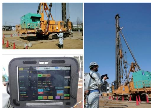
写真-1 施工管理装置のタブレット化
