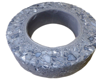
5%濃度の硫酸水溶液に112日間浸漬後の質量減少率
