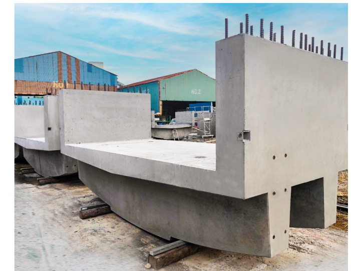
セグメント用内部構築
