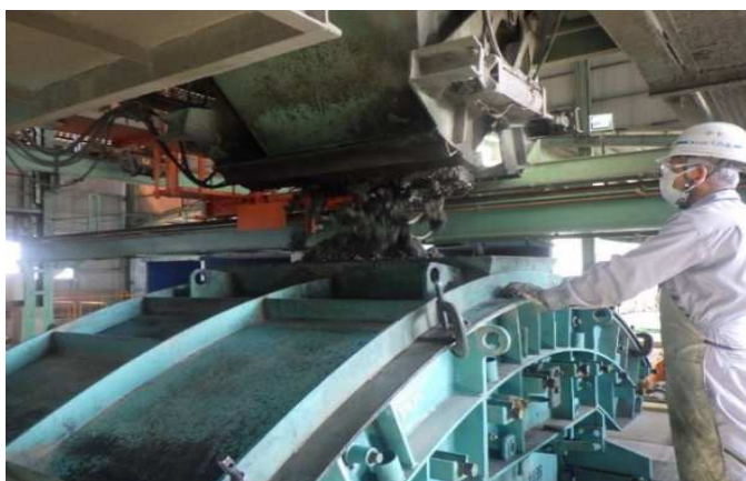
写真2 セグメント製品のコンクリート打込み
