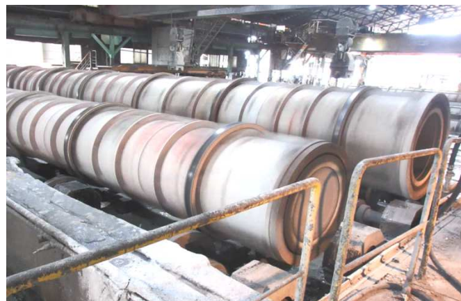
写真3 パイル製品の遠心成形工程
