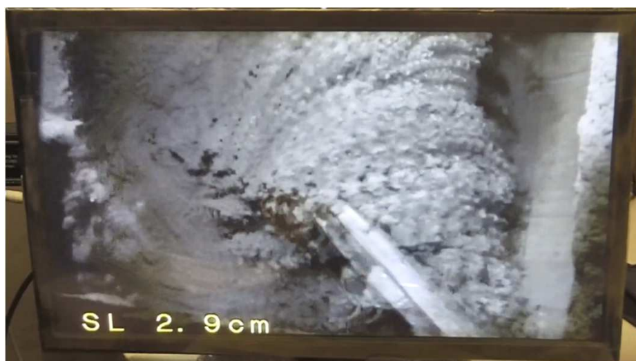
写真1 セグメント工場に実装したスランプ予測システムの画面（左下の数値が予測値）
