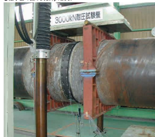
●継手部の曲げ試験(φ1200)
