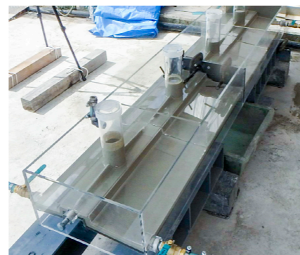
無収縮モルタル充填性確認試験
