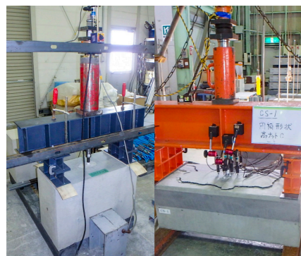
GP鉄筋引き抜き試験
