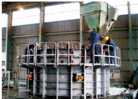
振動締固め成形方法
