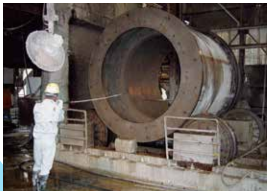
遠心力締固め成形方法
