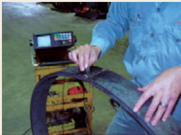
④ 外リング溶接部の超音波試験状況
