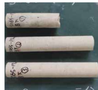
杭周固定部コア
