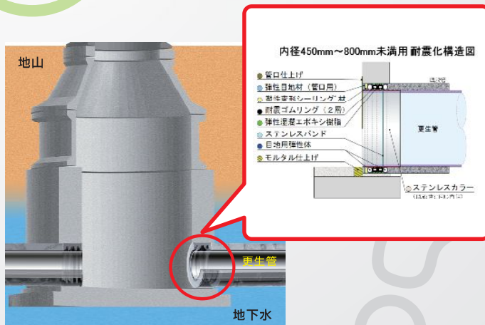
3. 既設管切削除去部にステンスカラーを装着します。
