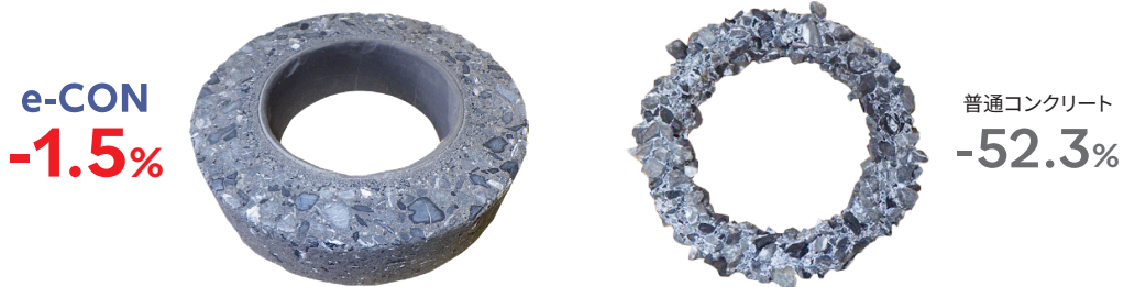
5%濃度の硫酸水溶液に112日間浸漬後の質量減少率
