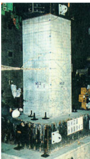
正負交番水平載荷試験状況
