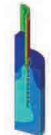
FEM解析による応力コンター図
