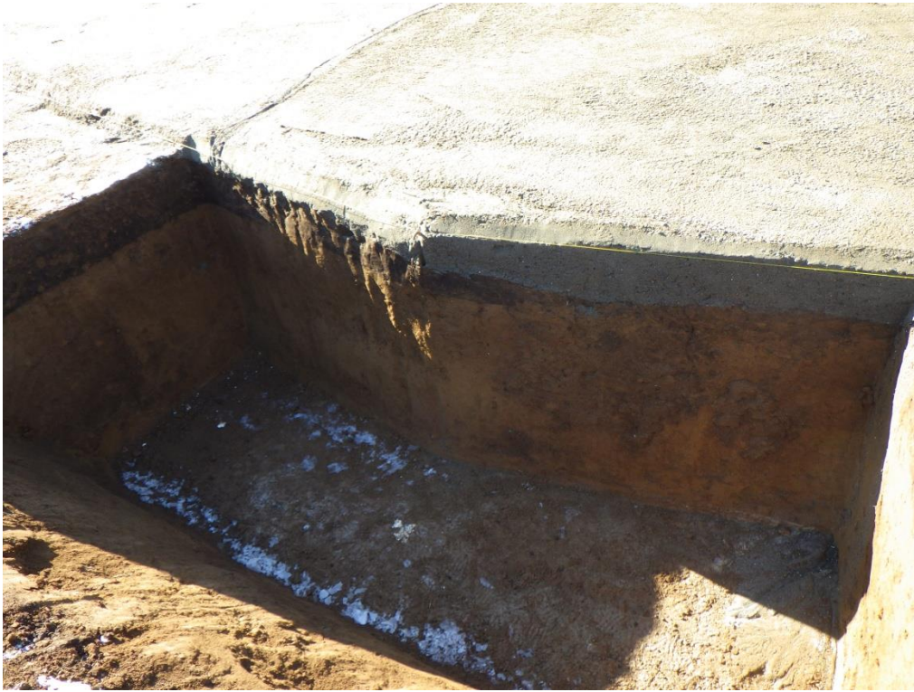
(参)写真-69 実験 CASE 5 (土被り 0.2m) 背面抵抗土圧なし
