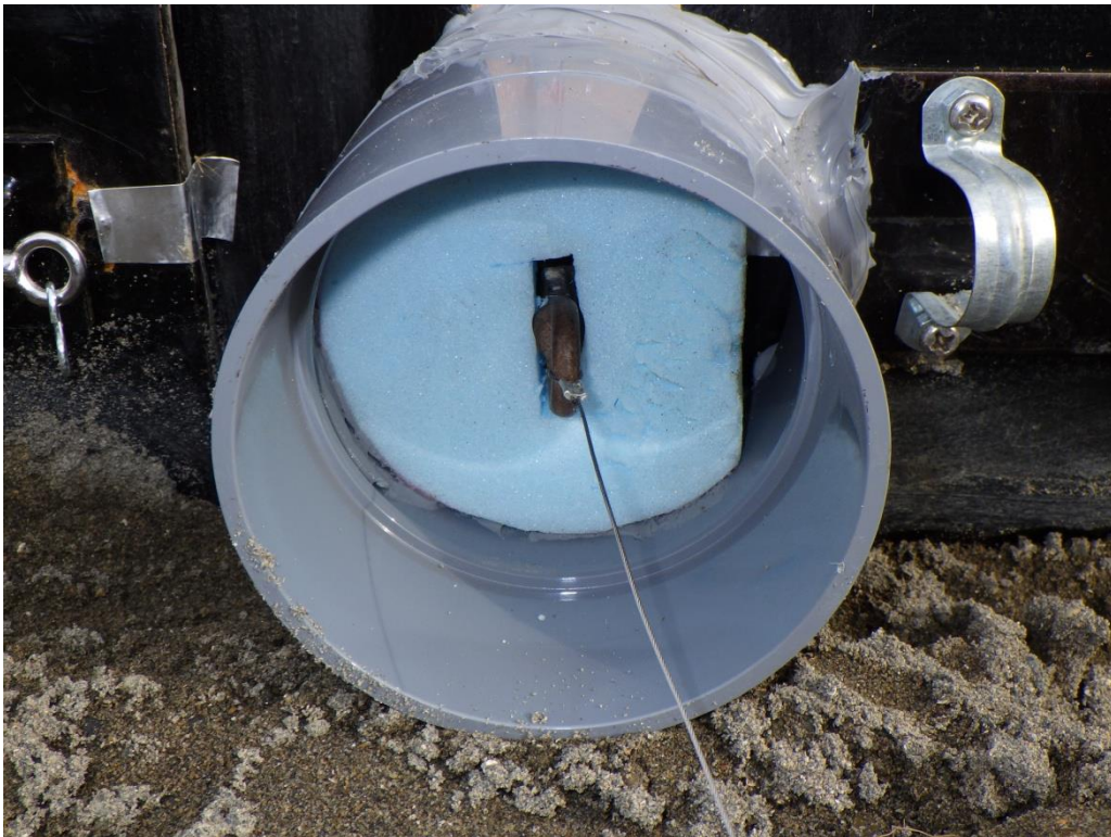
(参)写真-30 ワイヤ型変位計ワイヤ取付け
