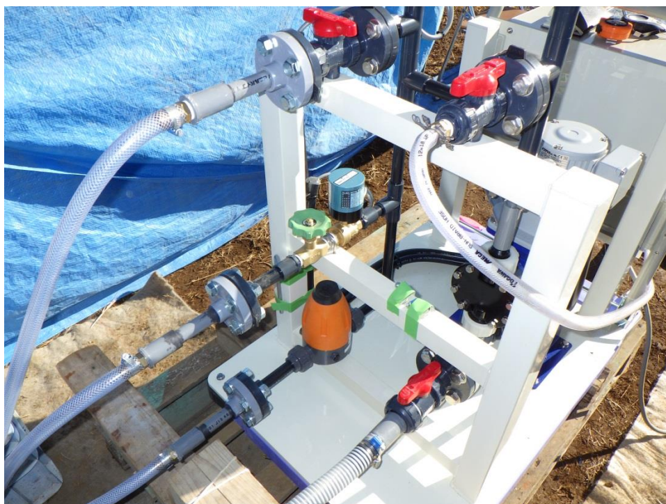
写真3.7 内水圧負荷装置設置状況
