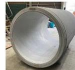
材料構成 e-CONで製造したヒューム管
