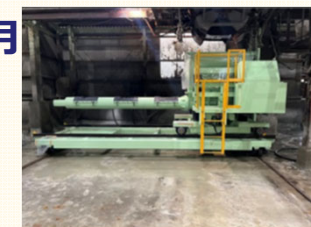
ヒューム管投入ライン
