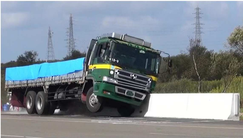
壁高欄 実車衝突試験の様子
