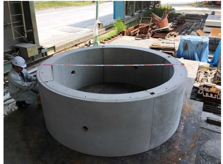
RCセグメント 新継手による水平仮組み状況
