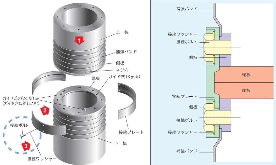
T・P JOINTの概要図
