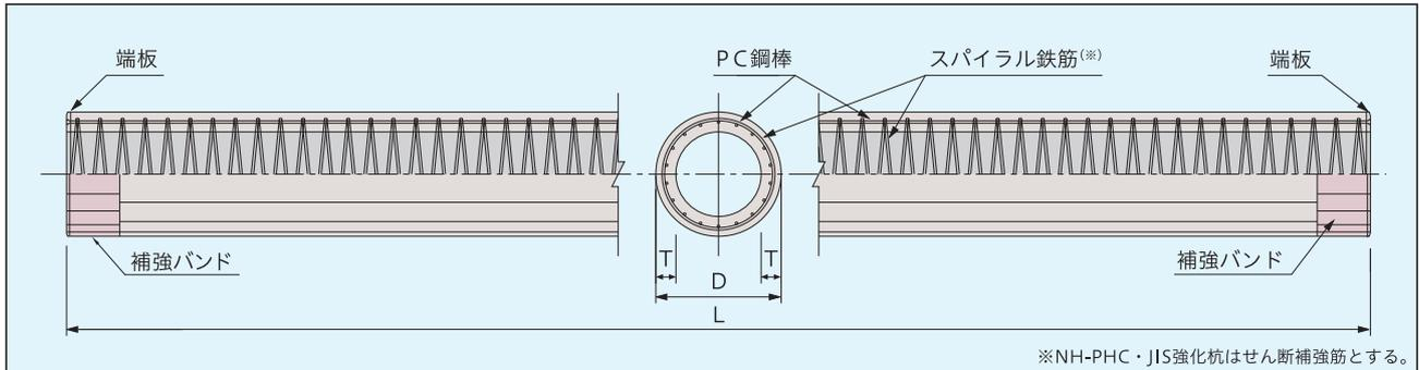
NH-PHC・SATパイル／NH-SSPHC・SATパイル／NH-123PHC・SATパイル
