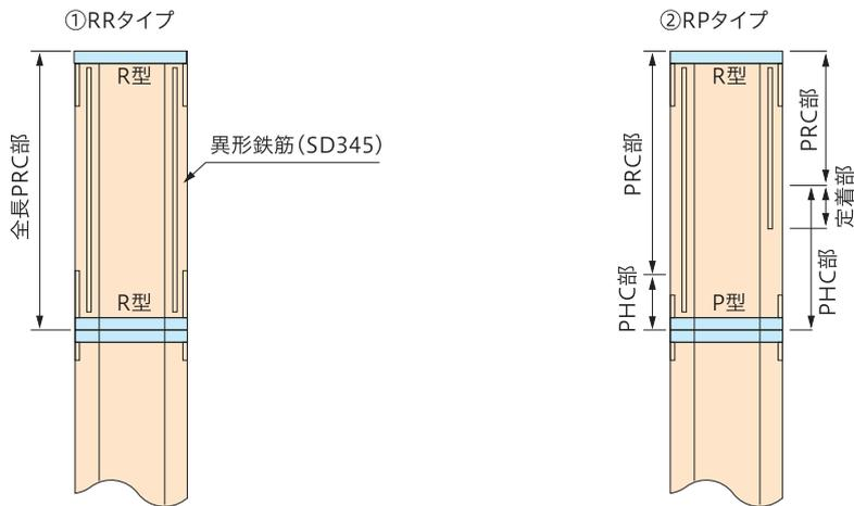
全長に異形鉄筋を配筋し全長PRCパイルとする場合。
