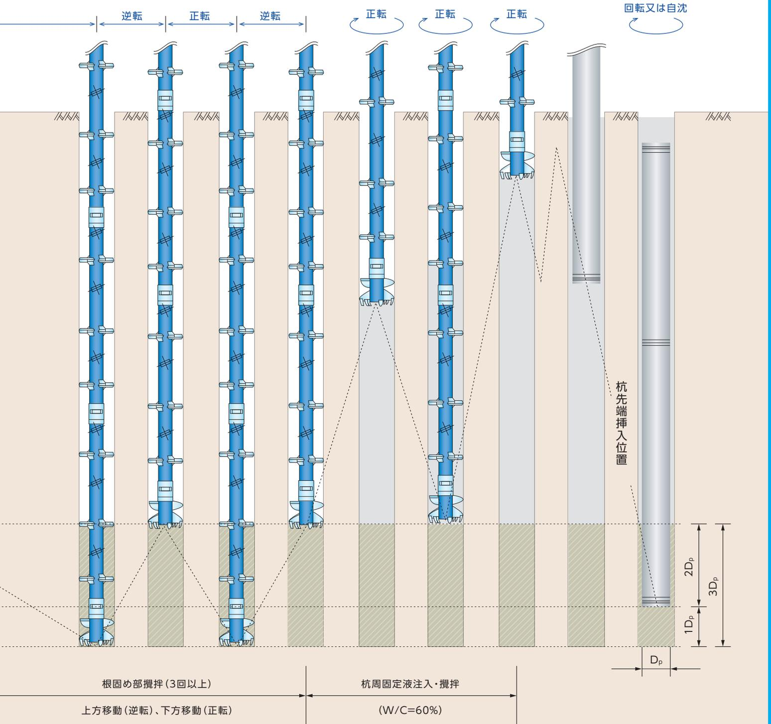
※オーガの回転方向は標準的な例を示すが、礫質地盤等で掘削作業時にオーガが拘束されやすい場合は、孔壁の安定を図るため、正転・逆転を併用する場合があります。
