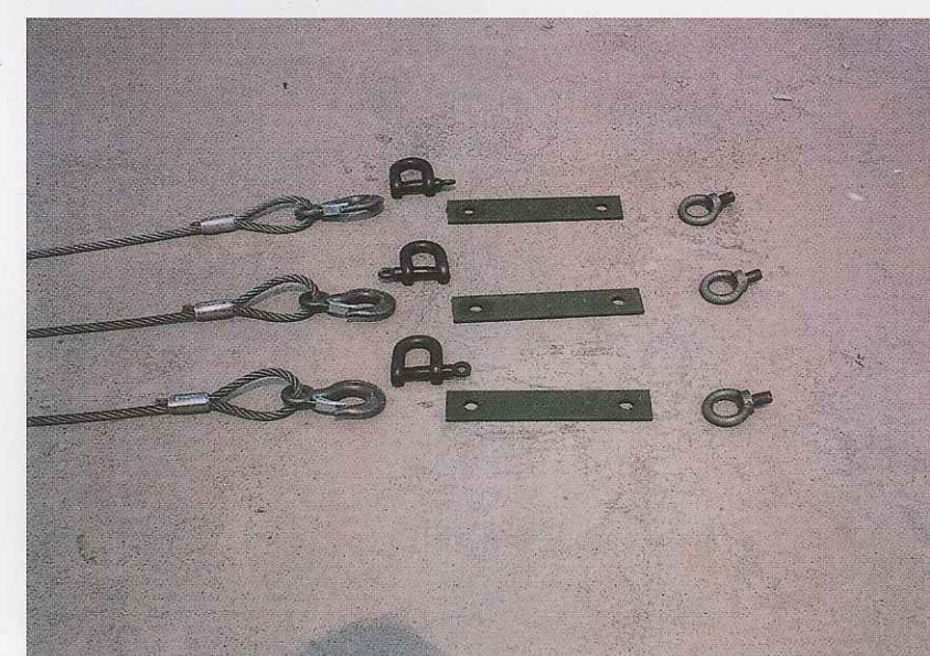
吊り具② (3号～5号) シャックル、プレート、アイボルト
