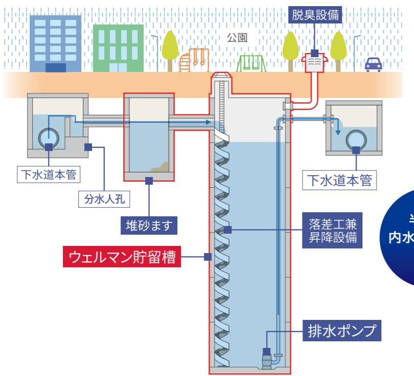
ウェルマン貯留槽は、貯留施設のパッケージ化を実現した円筒型の縦型貯留施設です。PCウェル工法による施工のため、省スペース・近接施工も可能です。ピンポイント貯留なので、既設管路の大幅な見直しを必要としません。25m×30m程度の施工スペースを確保すれば、内径8m、深さ30mの立坑として1500m<sup>3</sup>程度の貯留が可能になる省スペース・縦型の貯留施設です。
