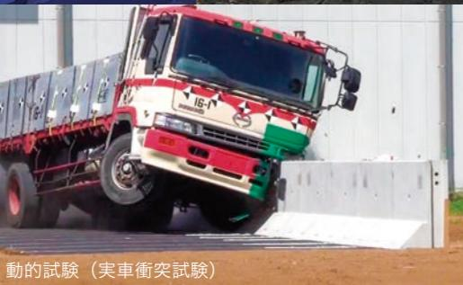
動的試験（実車衝突試験）
