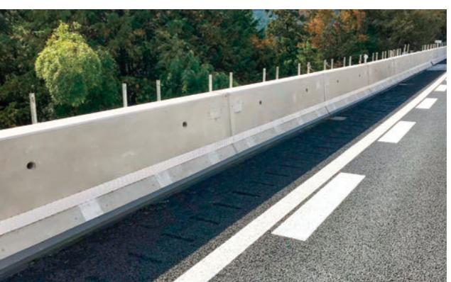
施工性、高耐久、維持管理性に優れたプレキャスト壁高欄(ガードフェンス)です。床版との接合・部材間の連結をシンプルなボルトで結合するため、優れた施工性を有します。取替可能なボルトには防蝕処理が施されており、維持管理が容易なほか、高強度かつ耐久性に優れています。
