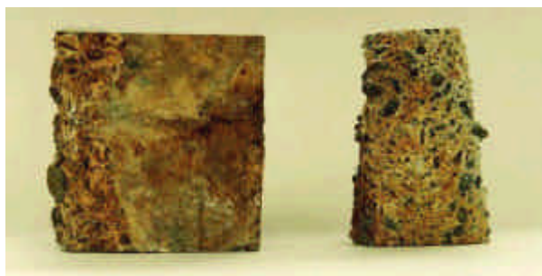
写真 - 2 汚泥処理槽内に 5.5 年曝露した供試体 ビックリート 普通コンクリート
