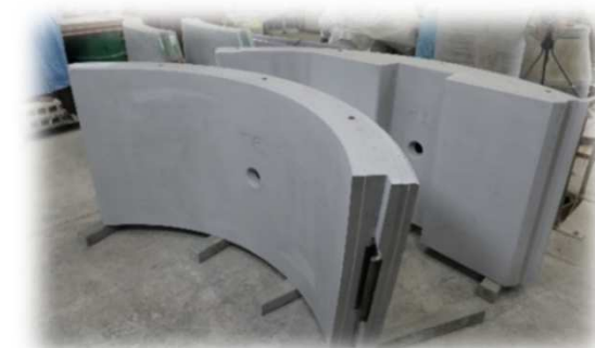
e-CONを用いて製造したRCセグメント
