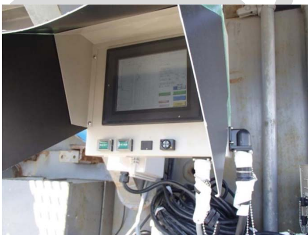
施工管理装置
