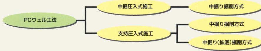
PCウェル工法は沈設制御の方法により上図のように大別されます。
