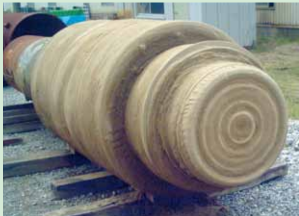
掘り起こした根固め球根の外観 所定の形状と寸法を確認
