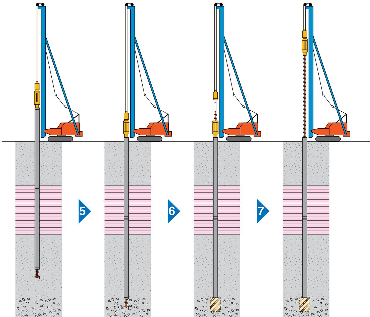
再び駆動部を起動し、油圧又はモンケン軽打等を併用しながら杭を貫入させる。
