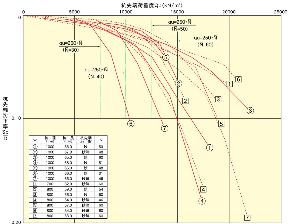
上図は杭の鉛直載荷試験における杭先端荷重と杭先端沈下率の関係を例示した図であります。杭先端部の平均 $\bar{N}$ 値から支持力式における係数 $\alpha$ を250とした場合で、 $\bar{N}=30\sim60$ 時の杭先端地盤設計極限荷重度 ( $250\bar{N}$  kN/m<sup>2</sup>) を一点鎖線で示しておりますが、両図に示すように鉛直載荷試験の結果は係数250を上廻っており、杭先端拡大球根が確実に支持機能を発揮していることが明瞭であります。
