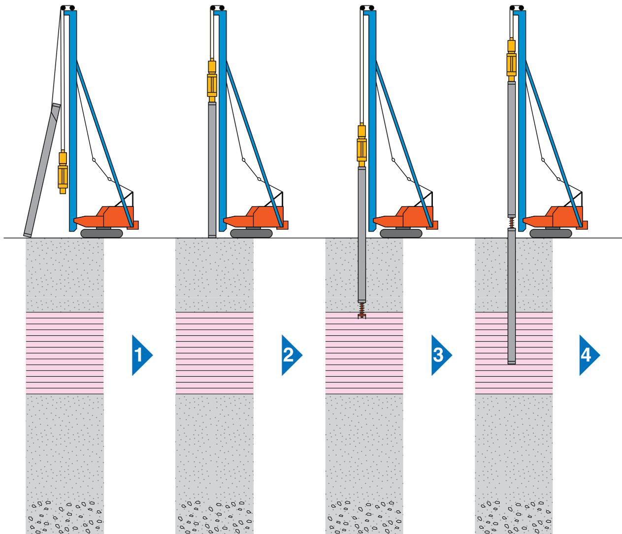
杭中空部にスパイラルオーガを挿入した後、補助クレーンによって吊り込む。
