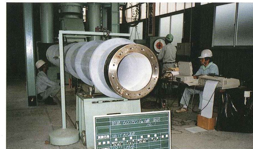
【FKパイプ曲げ試験状況】
