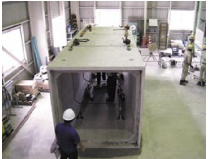
曲線施工試験 (IB50 タイプ)
