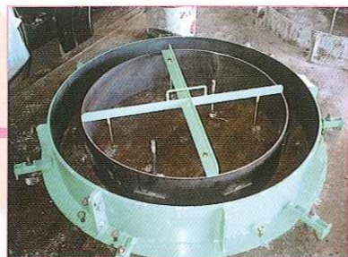
鋼板リングを型枠にセット
